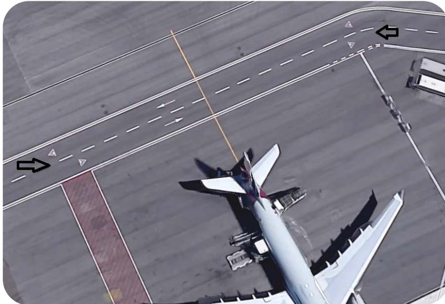
Figura 8 - Segnaletica orizzontale jet blast sulla viabilità
